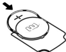
**Paso 4:** Inserte la batería nueva, manteniendo el borne "+" hacia arriba.
