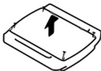
**Paso 1:** use un destornillador de 1,8 mm para quitar los 4 tornillos en la parte posterior del control remoto, luego puede abrirlo.
