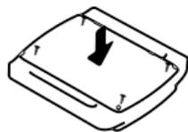
**Schritt 6:** Installieren Sie alle 4 Schrauben wieder in der Abdeckung.
