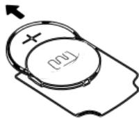
**Schritt 3:** Heben Sie die Platine an und schieben Sie die Batterie heraus, wie in der Abbildung gezeigt.
