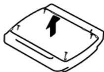
**Schritt 1:** Verwenden Sie einen 1,8-mm-Schraubendreher, um die 4 Schrauben auf der Rückseite der Fernbedienung zu entfernen, dann können Sie sie öffnen.
