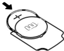
**Schritt 4:** Setzen Sie die neue Batterie ein und halten Sie den „+“ Pol nach oben gerichtet.
