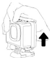
■ Öffnen Sie den schwarzen Verschluss oben am wasserdichten Gehäuse.
