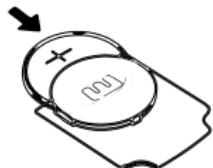
ステップ4: 新しいバッテリーを、「+」極を上に向けて取り付けます。
